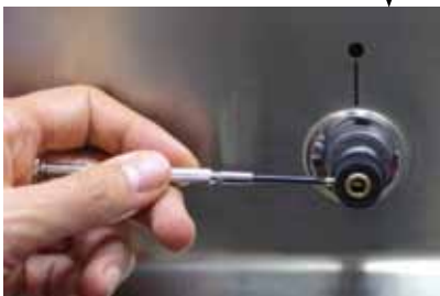
2 Adapter auf Rundachse festschrauben ...
