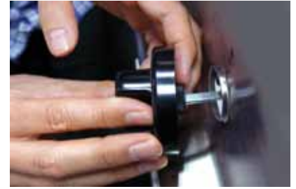
3 Knebel auf Adapter setzen (auf Nullstellung achten)
